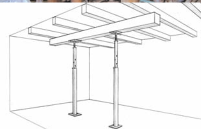
Des colonnes à vérin en acier constituent de bons appuis supplémentaires.
